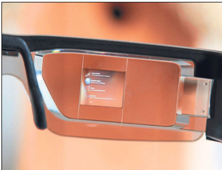
Auf der halbtransparenten Anzeige auf der Innenseite des Brillenglases werden Informationen eingeblendet. Fotomontage: Schulz
