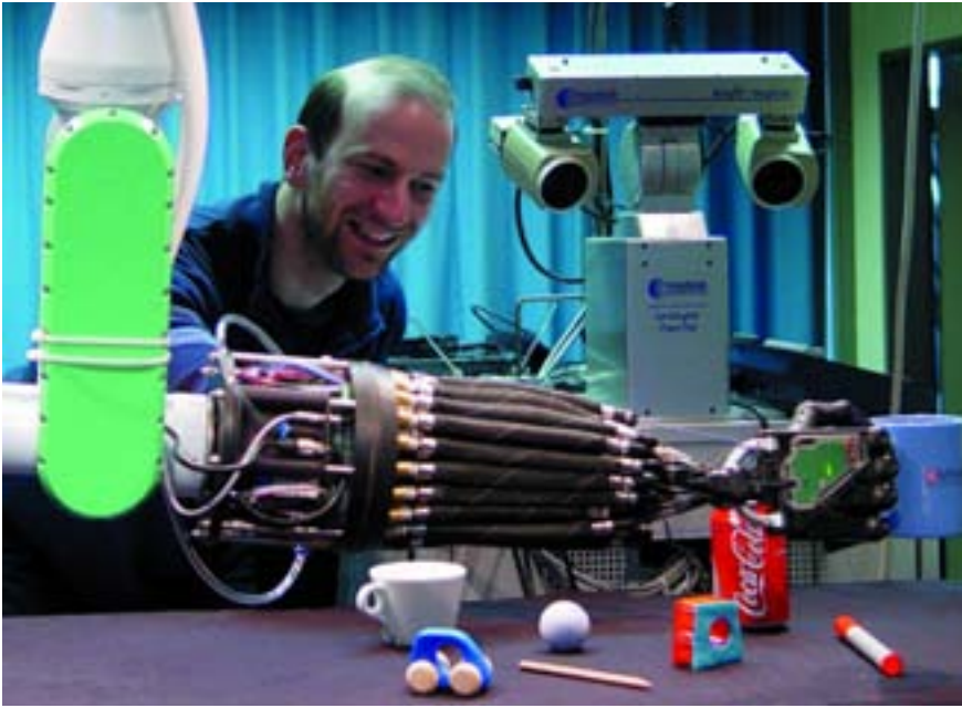
Abbildung 6: Erforschung von Lernen und Imitation am Beispiel des Greifens mit einer mehrfingrigen Roboterhand
