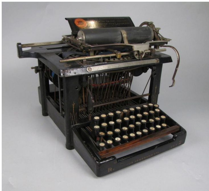
Abbildung 2: Remington Standard No. 2 , die Schreibmaschine, die die QWERTY-Belegung verbreitete. Quelle: National Museum of American History © 3
