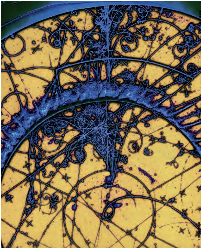
Teilchenspuren in einer Blasenkameraufnahme: Teilchen und Antiteilchen bewegen sich auf entgegengesetzt gekrümmten Bahnen im Magnetfeld.
