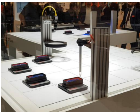
Abbildung 1: Intelligenten Produkttransport auf Basis magnetischer Levitation für den industriellen Einsatz.
