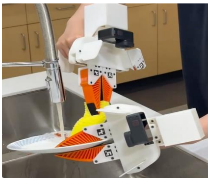
Abbildung 1: Zwei UMI-Greifer beim Demonstrieren eines Geschirrspülvorgangs.
