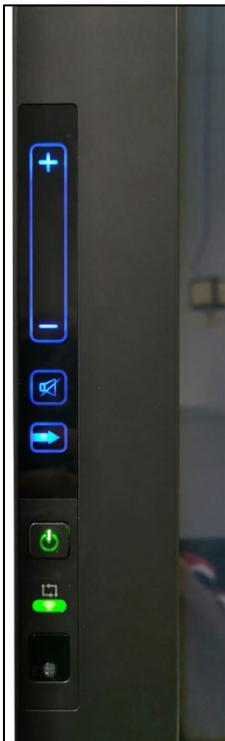
Abbildung 2: Linke Seite des SMART Boards mit Power-Taste
